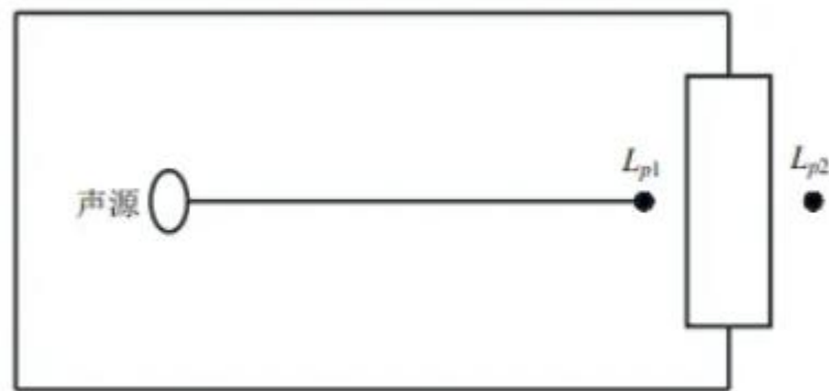
图 4-3 室内声源等效为室外声源图例
